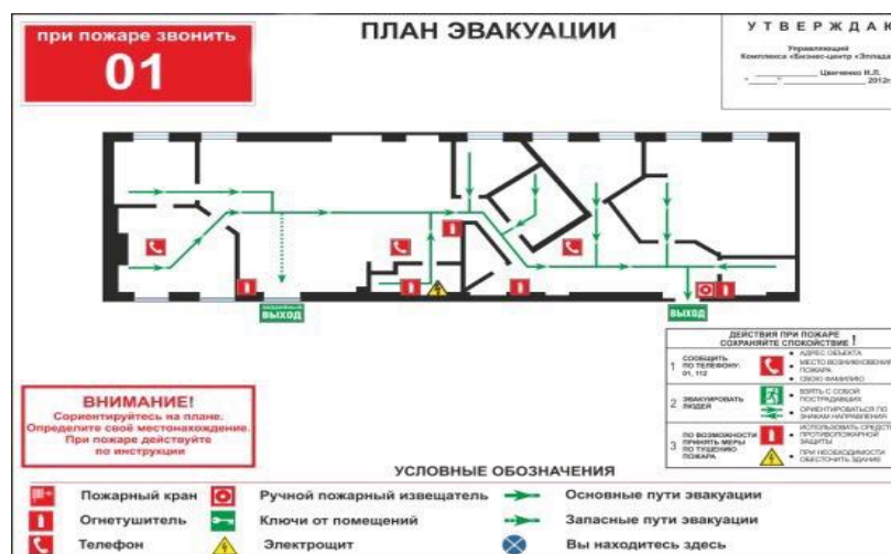
Рисунок 14 – План эвакуации офисного здания
