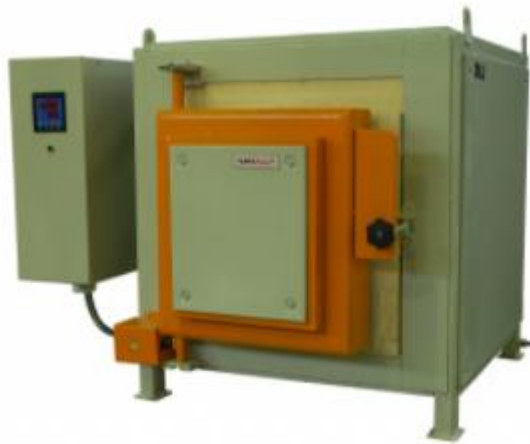
Рисунок 1.14 – Печь камерного типа ПКМ 2.4.2
