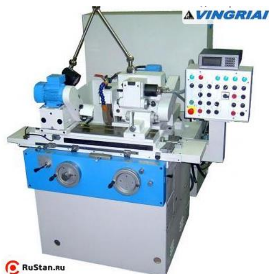
Рисунок 1.15 – Круглошлифовальный универсальный станок (полуавтомат) VINGRIAI 3U10MSF1-250
