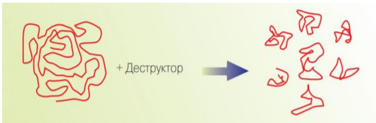
Рисунок 16 – Схема разрыва цепочек полимера
