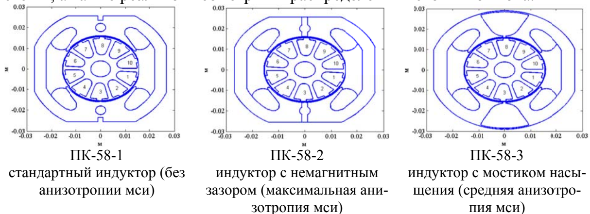
Рис. 2. Варианты исследуемых КЭМ с индукторами с различной анизотропией магнитных свойств (размеры по осям координат указаны в метрах).
