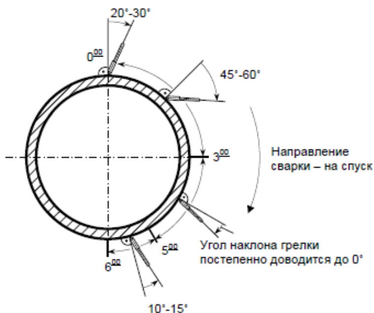
Рисунок 3.3 – Изменение угла наклона сварочной горелки при механизированной сварке самозащитной порошковой проволокой неповоротных кольцевых стыковых соединений труб
