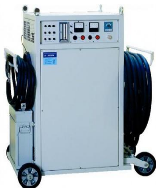
Рисунок 3.6 Установка индукционного нагрева УИИТ-100-2,4
