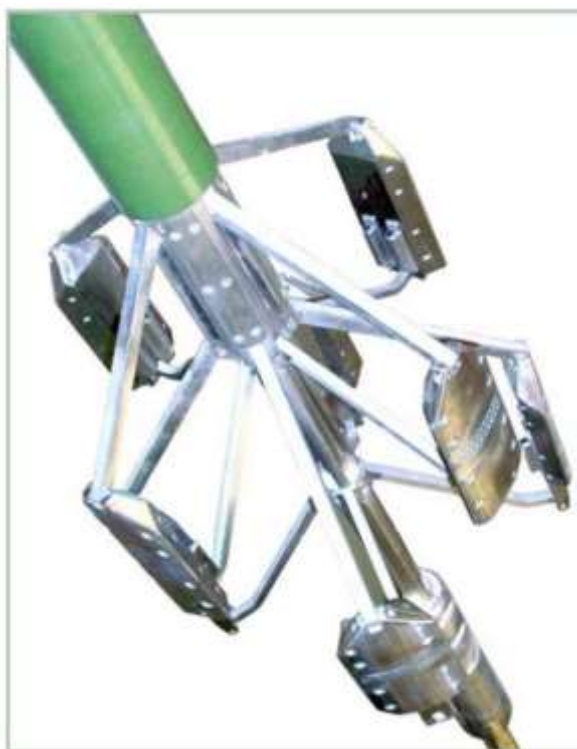
Рисунок 3.2 – Внешний вид нижней (записывающей) части микросканера [7]
