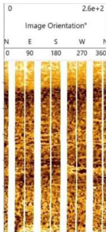
Рисунок 3.3 – Результат записи электрических скважинных микросканеров
