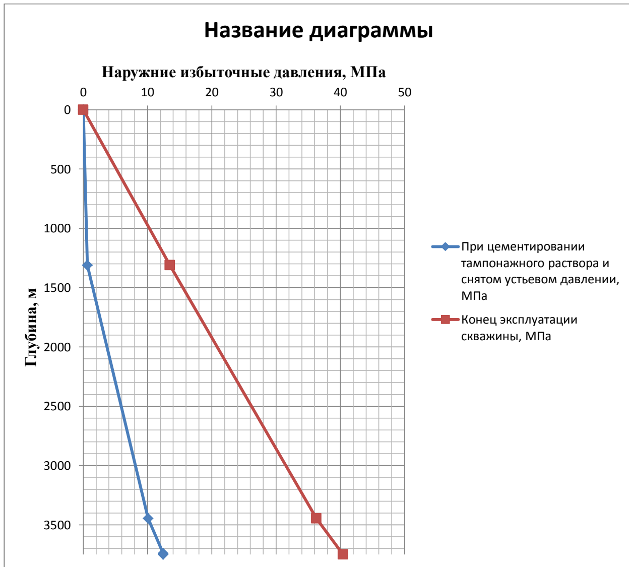
Рисунок 2.3 – Эпюра наружных избыточных давлений эксплуатационной КОЛОННЫ
