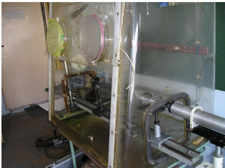
Рис. 20. Экспериментальная установка голографического контроля физических параметров струи распыляемого топлива.
