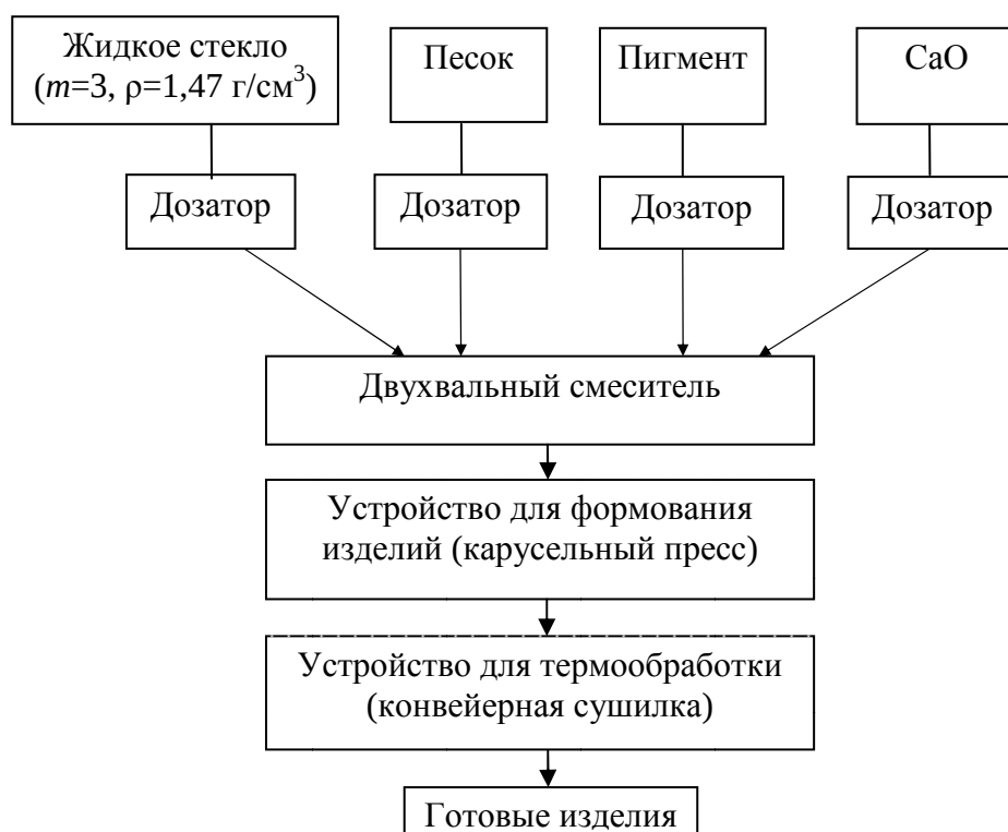
Рис. 11. Технологическая схема получения жидкостекольных композиционных материалов с использованием пигментов на основе шламов водоочистки
