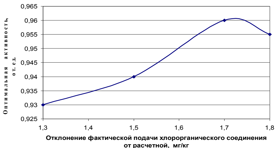
Рисунок 9 – Влияние содержания хлорорганических соединений на активность катализатора в присутствии сероводорода
