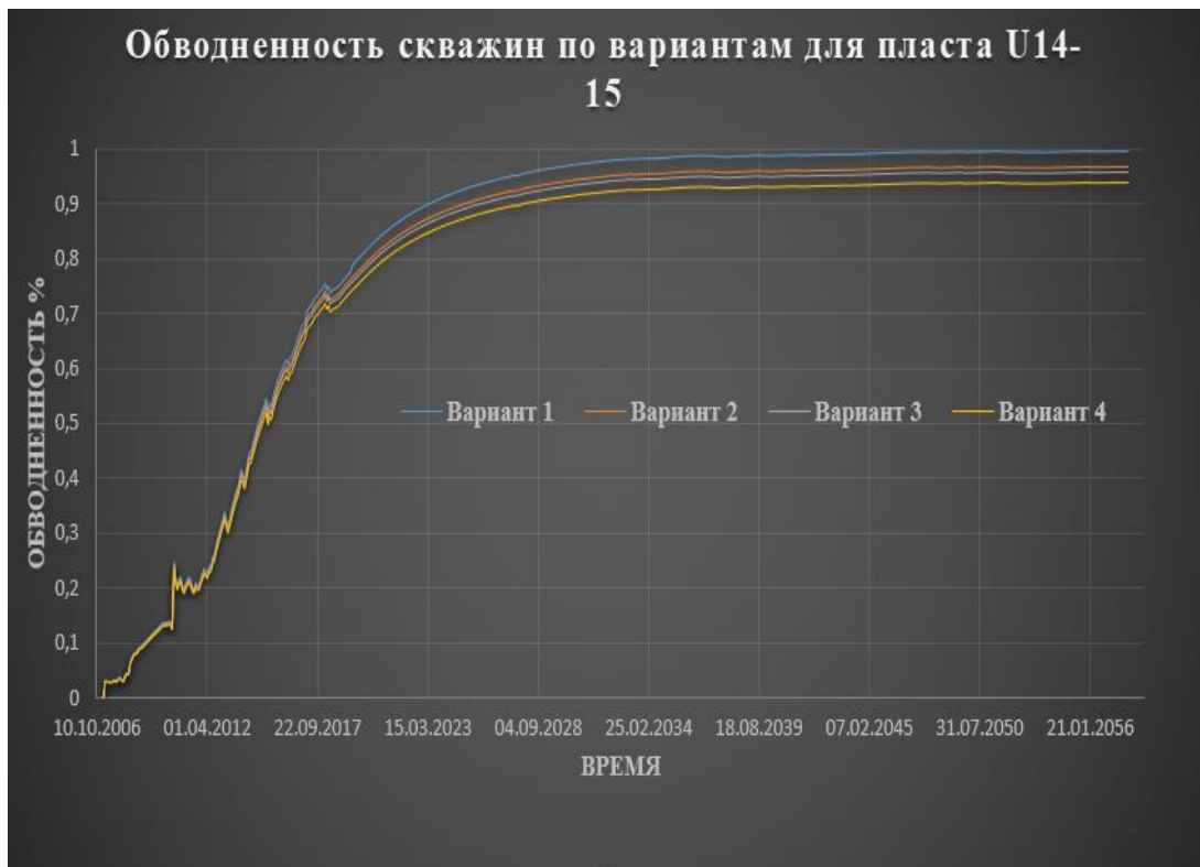
Рисунок 3.9 - График обводнённости скважин для вариантов разработки
