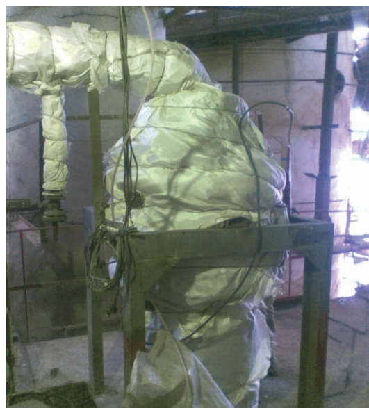
Рис. 16. Схема и внешний вид пилотного реактора окисления SO_2 в SO_3 : 1 и 2 – каталитические картриджи большого и малого диаметра; 3 – засыпка керамическая для обеспечения равномерности потока; 4 – крестовина для разделения; 5 – вата минеральная для заполнения пустот между 2 и корпусом реактора.
