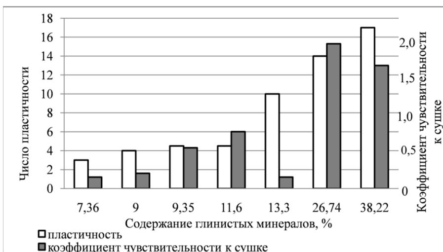
**Рис. 2.** Зависимость технологических свойств глинистого сырья от содержания фракций менее 1 мкм
