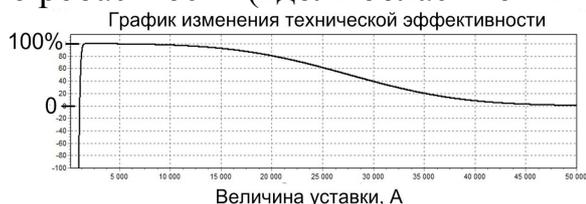
Рисунок 9 – График технической эффективности в зависимости от уставки для первой ступени
