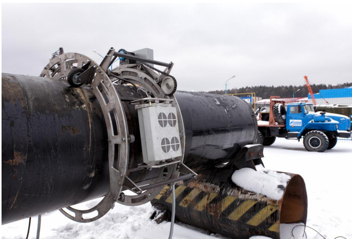
Рис. 9. Мобильный дефектоскопический комплекс.
