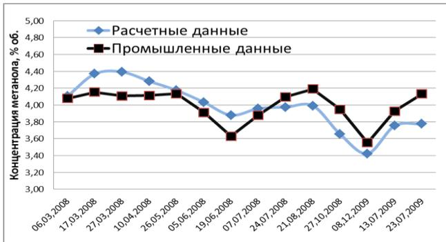
Рис. 7. Сравнение расчетной и промышленной концентраций метанола на выходе из реактора
