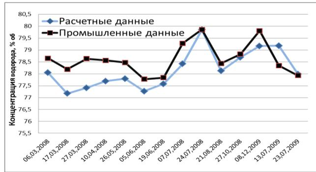
Рис.8. Сравнение расчетной и промышленной концентраций водорода на выходе из реактора
