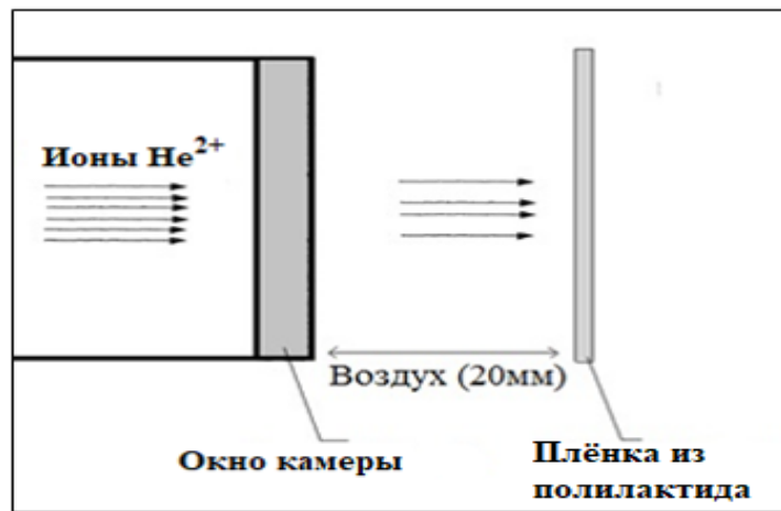
Рисунок 2.2 – Схема облучения плёнки полилактида
