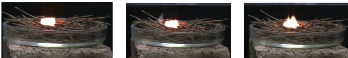
Рис. 2. Характерные кадры видеогаммы процесса зажигания ЛГМ (хвоя сосны): а) t=0,08 с – инертный прогрев слоя ЛГМ; б) t=0,20 с – появление пламени (зажигание ЛГМ); в) t=0,32 с – объединение пламени над частицей;
