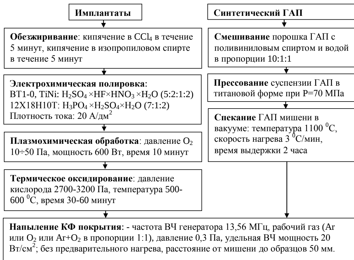
Рис. 1. Схема технологического маршрута формирования гибридных покрытий
