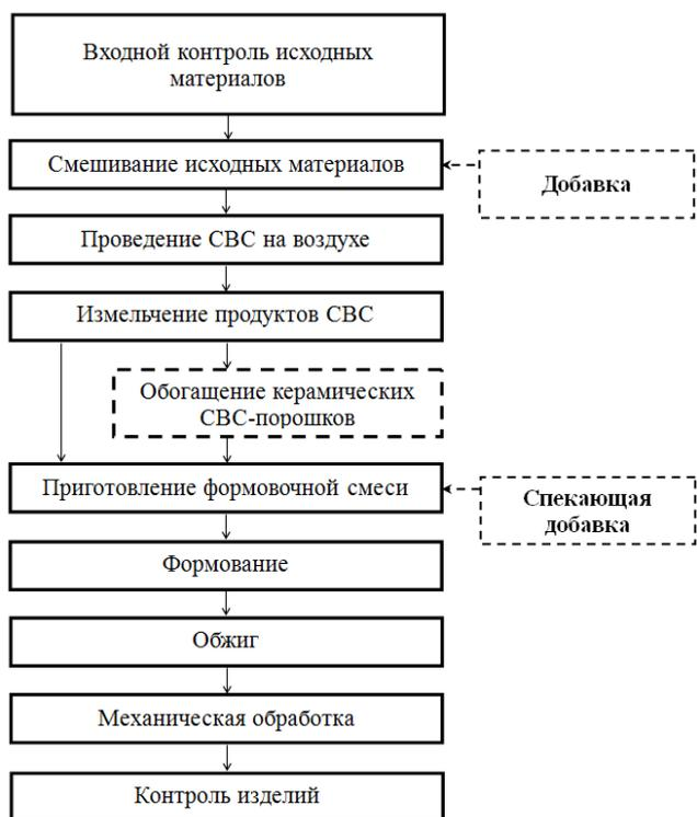
**Рисунок 16** – Технологическая схема получения композиционной керамики на основе СВС-порошков
