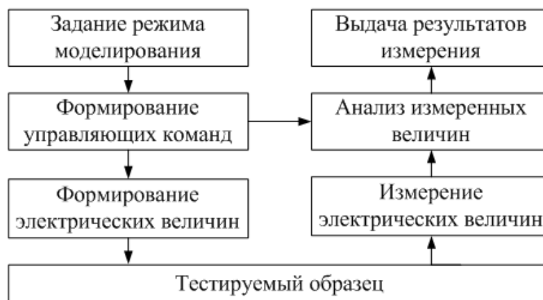
Рисунок 1.6 – Блок-схема алгоритма формирования модели ЛИАБ
