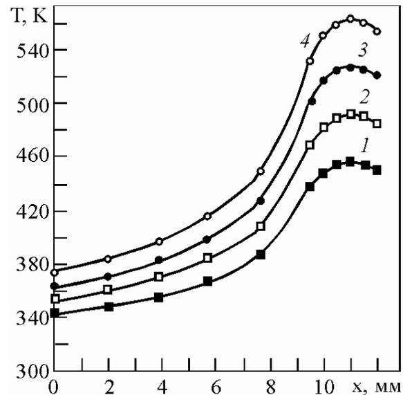
Рис. 2. Температурная зависимость по длине режущей кромки резца при различных тепловых потоках в зоне контакта режущего клина с обрабатываемым материалом: 1) 40; 2) 50; 3) 60; 4) 70 кВт/см<sup>2</sup>
