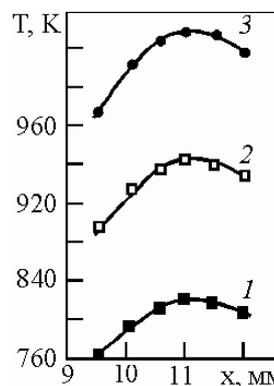
Рис. 3. Температурная зависимость по длине рабочего участка ВС режущей кромки резца при тепловых потоках: 1) 150; 2) 200; 3) 250 кВт/см<sup>2</sup>
