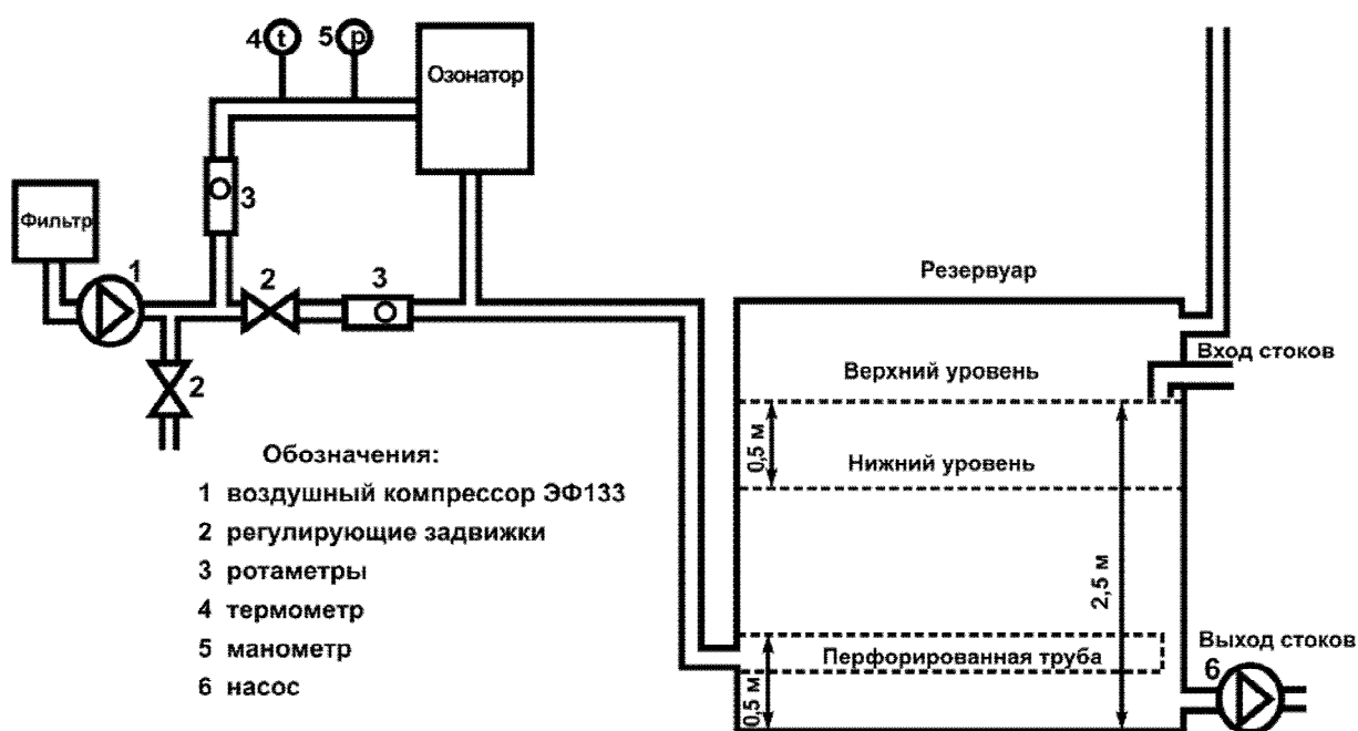
Рис. 12. Схема КНС КОС п. Пионерный
