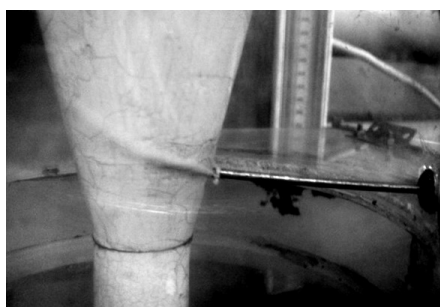
Рис. 7. Обратное течение при переходе диффузора в конфузор
