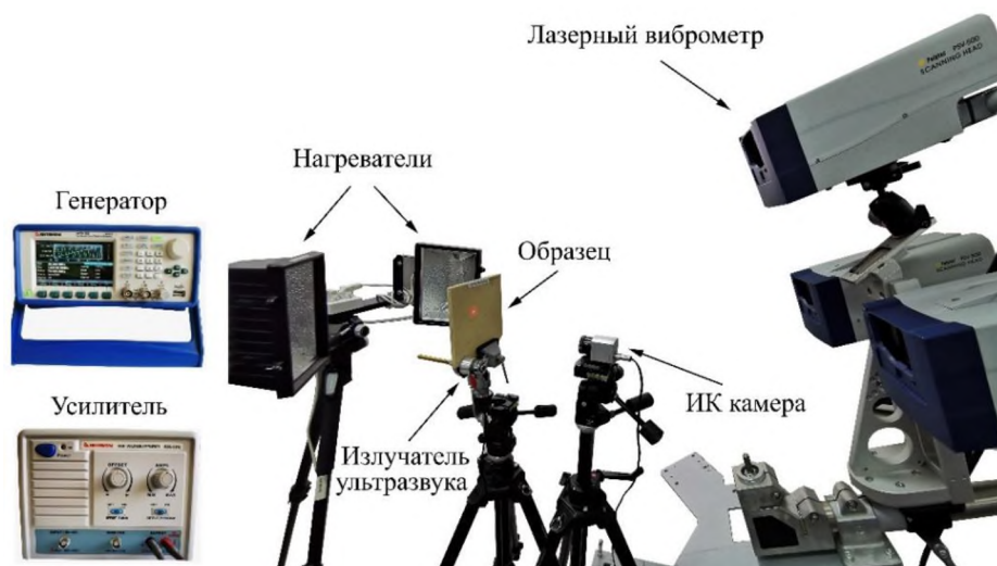
Рисунок 4 – Лабораторная установка для проведения синтеза данных ТК и ЛВ.
