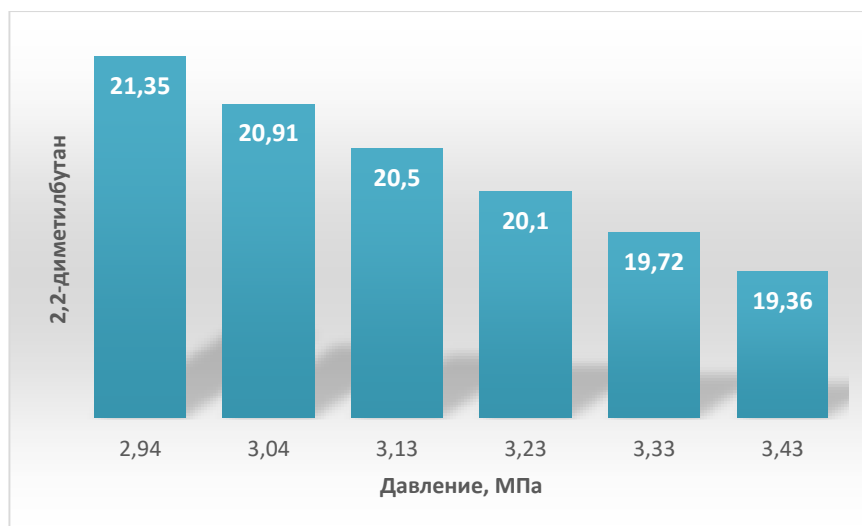
Рисунок 3.15 – Содержание 2,2-диметилбутана в продукте при различном давлении процесса
