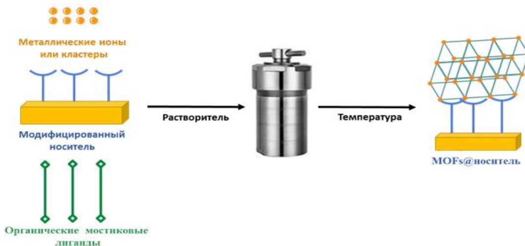
Рисунок 1.13 - Схема роста SURMOFs в процессе сольвотермального синтеза
