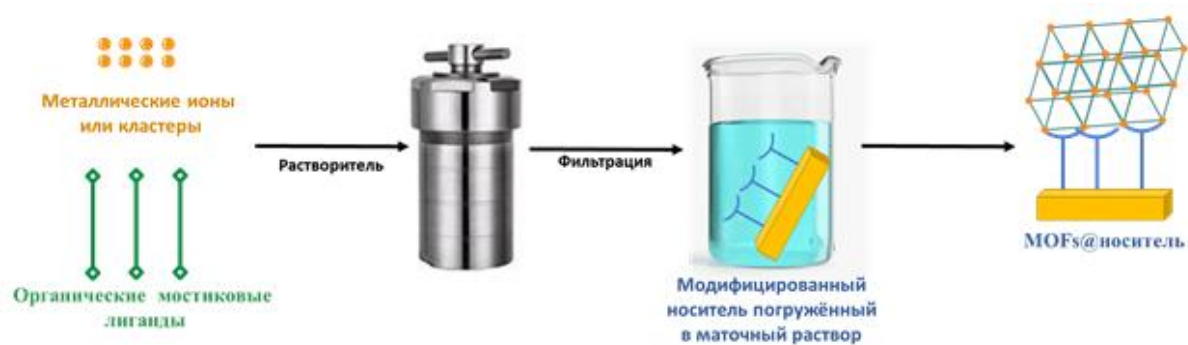
Рисунок 1.14 - Схема роста SURMOFs в процессе выдерживания в маточных растворах
