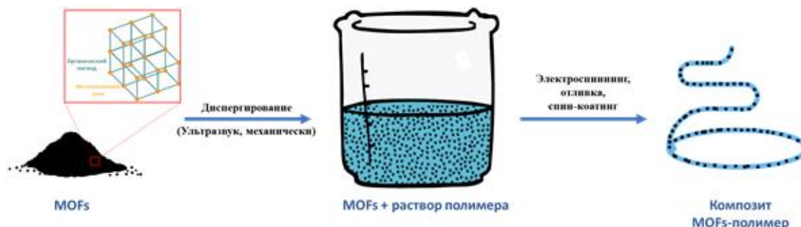
Рисунок 1.7 - Схема получения композитов MOFs-полимер
