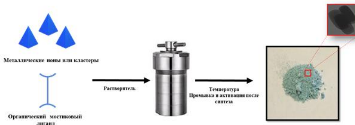
Рисунок 1.2 - Схема получения металл-органических каркасов сольвотермальным способом
