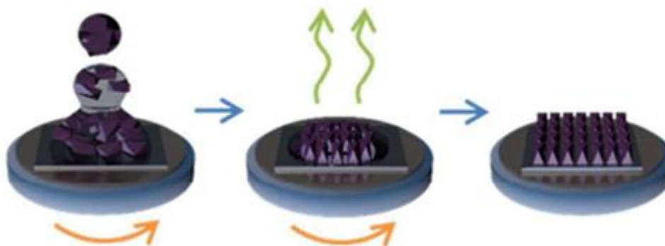
Рисунок 1.3 - Схема получения металл-органических каркасов спин-коатингом [22] © Royal Chemical Society, 2018
