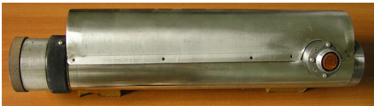
Рис. 7. Измерительный видеомодуль с телекамерой типа WATEC. Общий вид.
