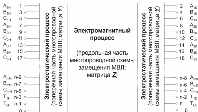
Рис. 3. Модель МВЛ в виде обобщённой n -полюсной многопроводной схемы замещения для m -цепной МВЛ с k грозозащитными тросами.
