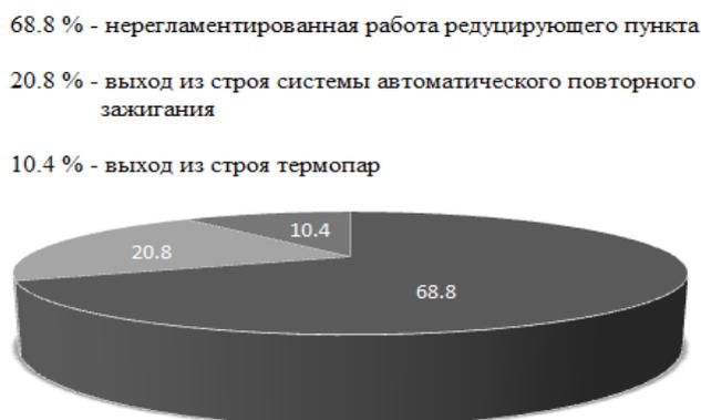
Рис. 3. Причины аварийного технического происшествия «обрыв пламени горелочного устройства»
