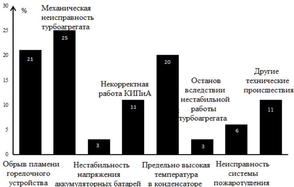
Рис. 2. Статистика типичных аварийных технических происшествий
