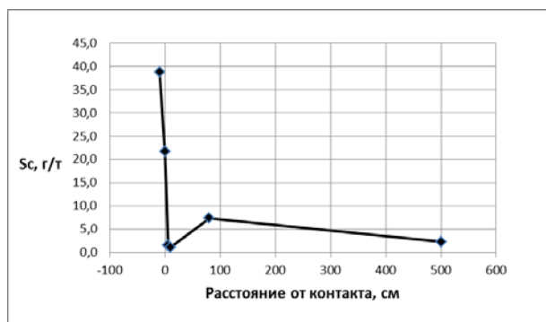
Рис. 7. Распределение Sc и Fe в угле вблизи контакта угольного пласта и дайки
