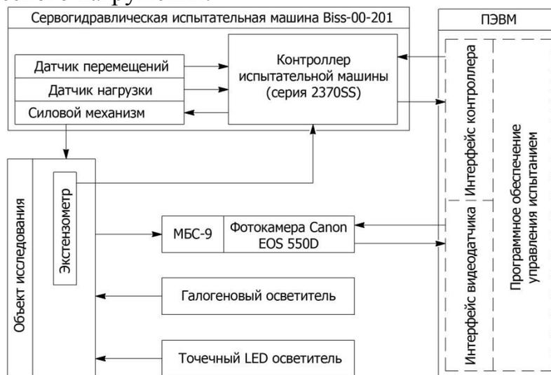
Рис. 5. Схема испытательного стенда для циклических исследований.
