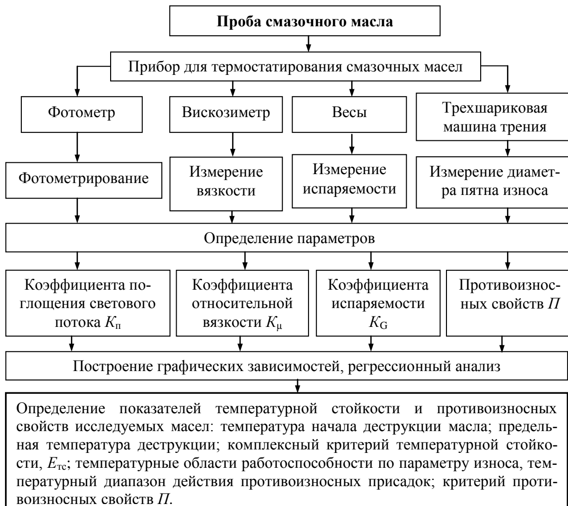
Рисунок 1 – Схема комплексного метода контроля триботехнических свойств смазочных масел
