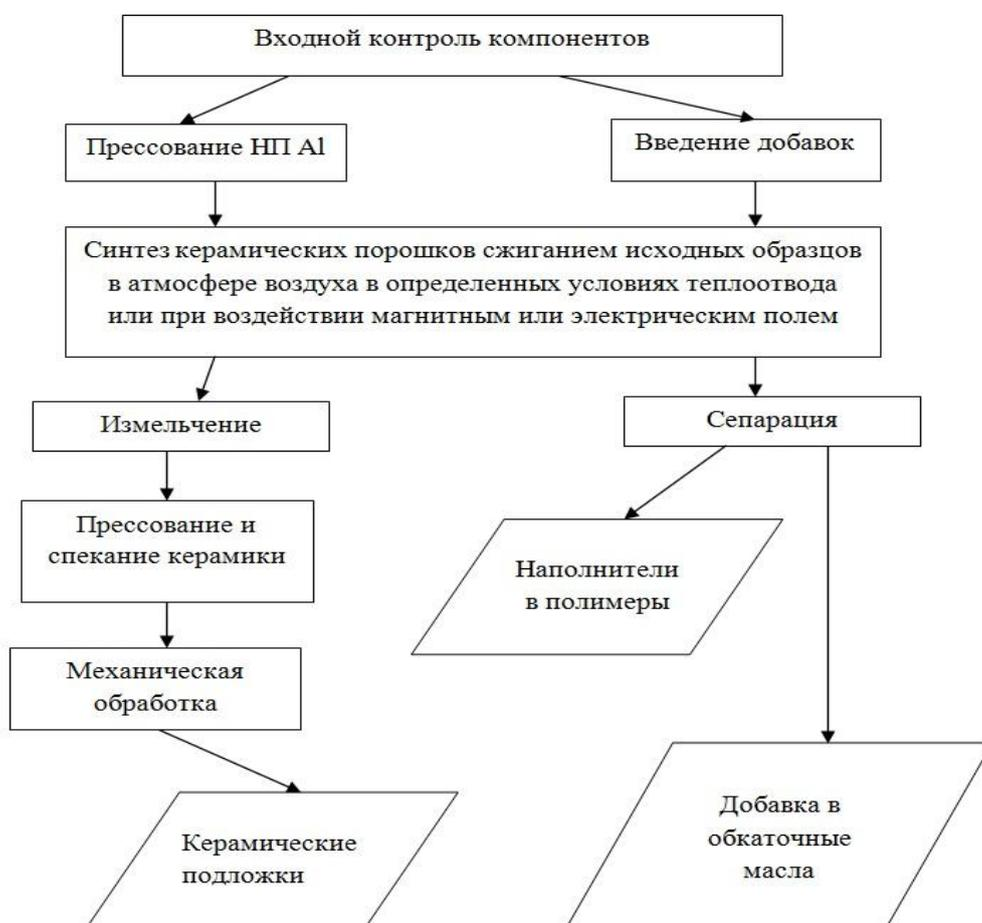
Рис. 11. Технологическая схема получения керамических нитридсодержащих порошков и материалов на их основе
