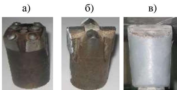
Рисунок 15 – Типовые буровые коронки
