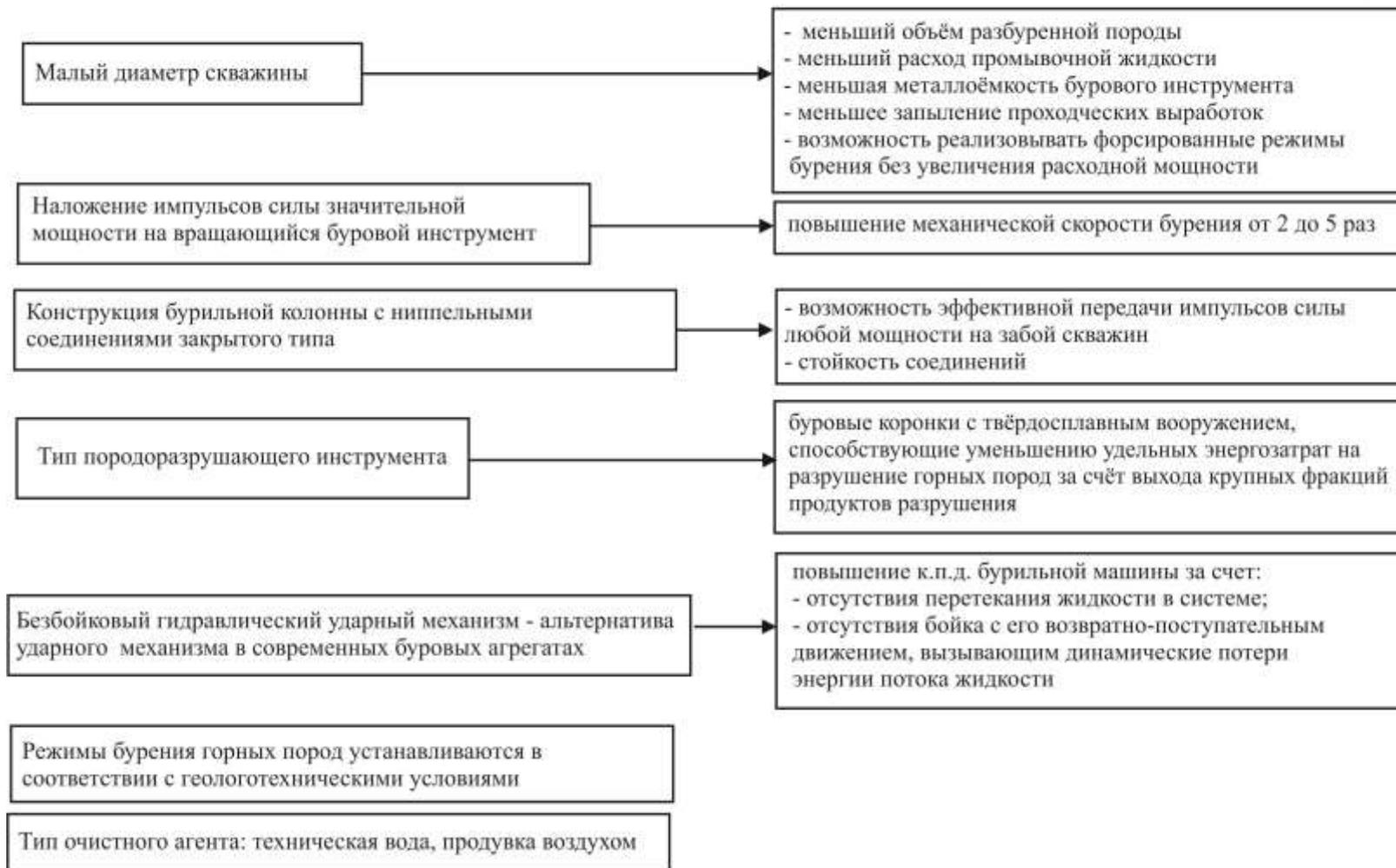
Рисунок 3 – Факторы, определяющие ресурсоэффективность технологии бурения геологоразведочных скважин ударно-вращательным способом
