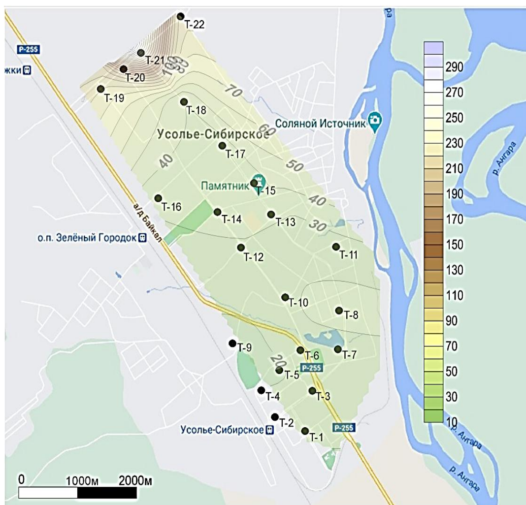
Рисунок 6.1.1 – Распределение ртути в зоне влияния предприятия «Усольехимпром» по данным опробывания сухой массы листьев тополя (нг/г)
