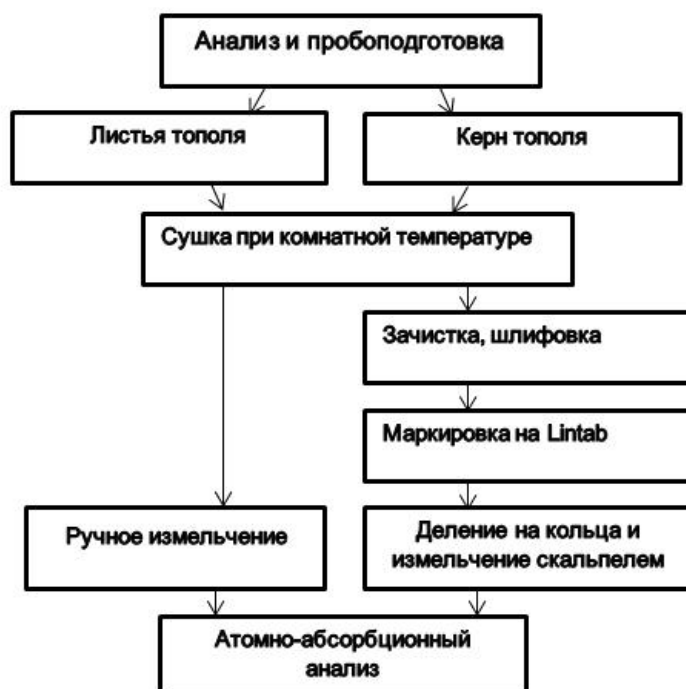
Рисунок 2.2.7 – Общая схема пробоподготовки проб листьев и годовичных колец древесных растений рода тополь
