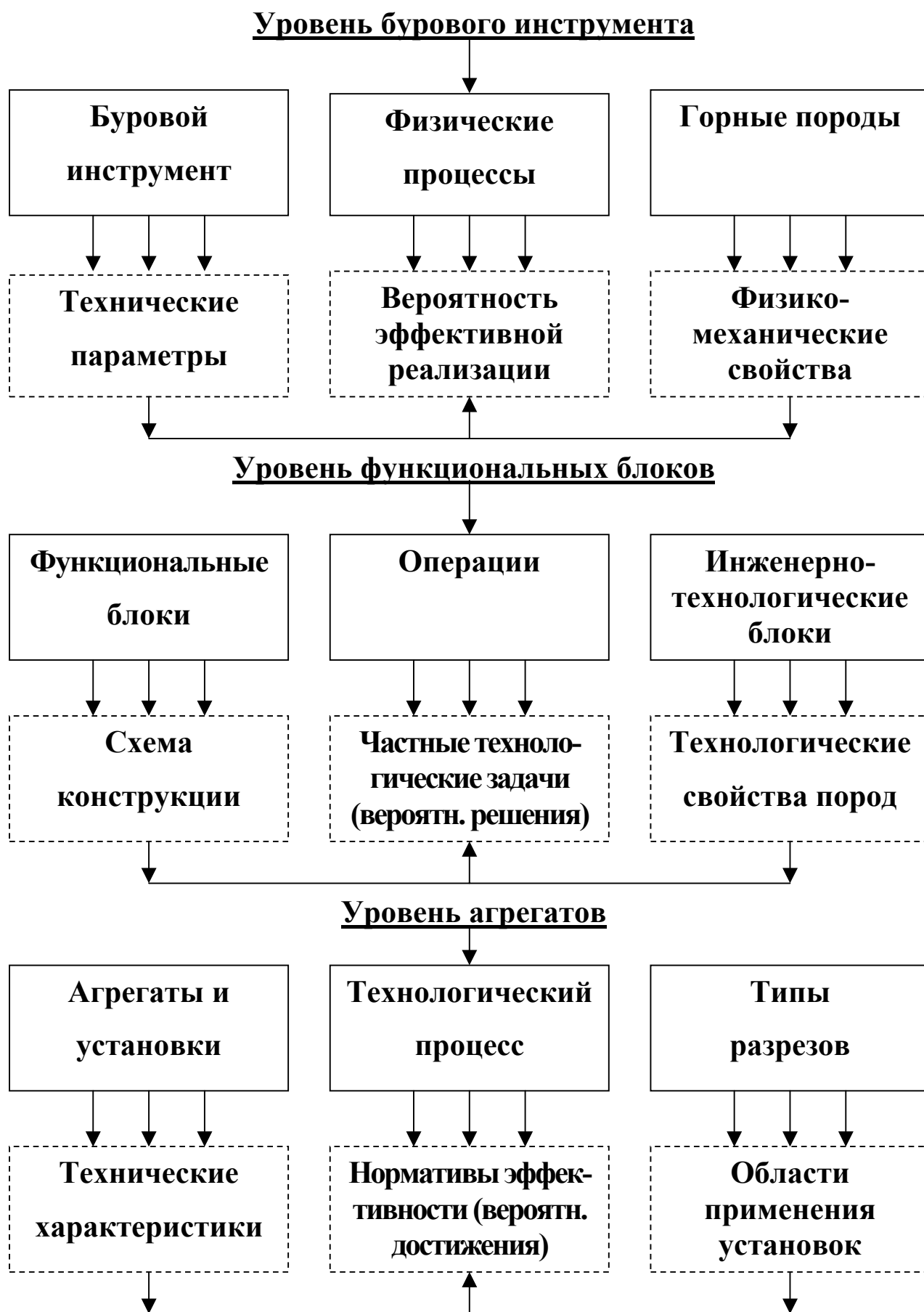
Рис.1. Схема системной организации бурового комплекса
