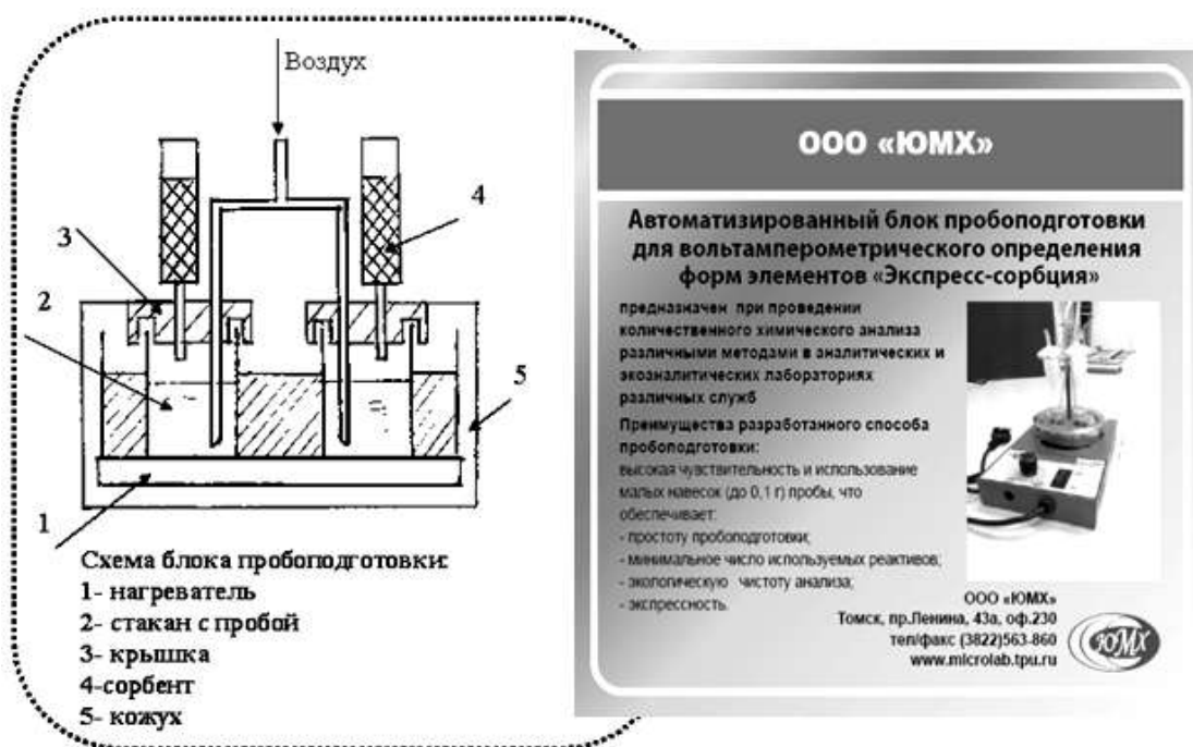
Рисунок 18 – Схема автоматизированного блока пробоподготовки для ВА-определения форм элементов
