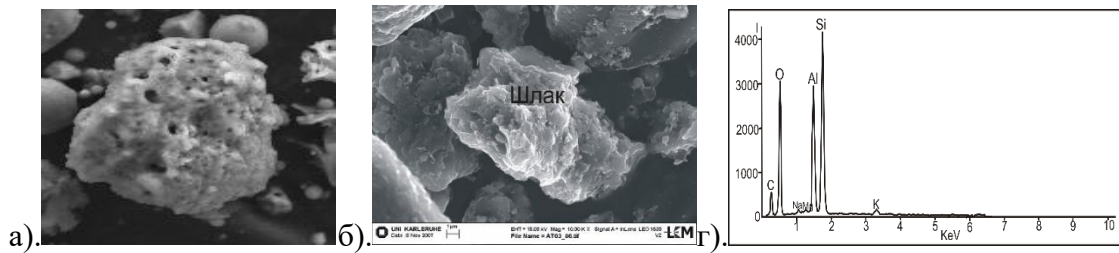
Рисунок 5.4.3. – Микрочастицы шлака в нерастворимом осадке снегового покрова в зоне воздействия ГРЭС-2 (г. Томск): а-б) фото; в) энергодисперсионный спектр (метод СЭМ)
