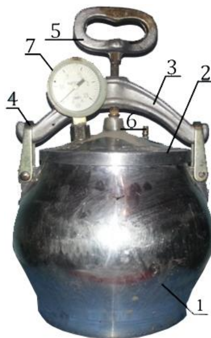
Рисунок 8. Устройство для определения коэффициента бародиффузии дисперсных материалов.
