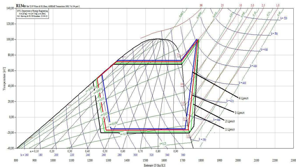
Рис. 2. Холодильный цикл в T-S диаграмме для всех рассматриваемых случаев
