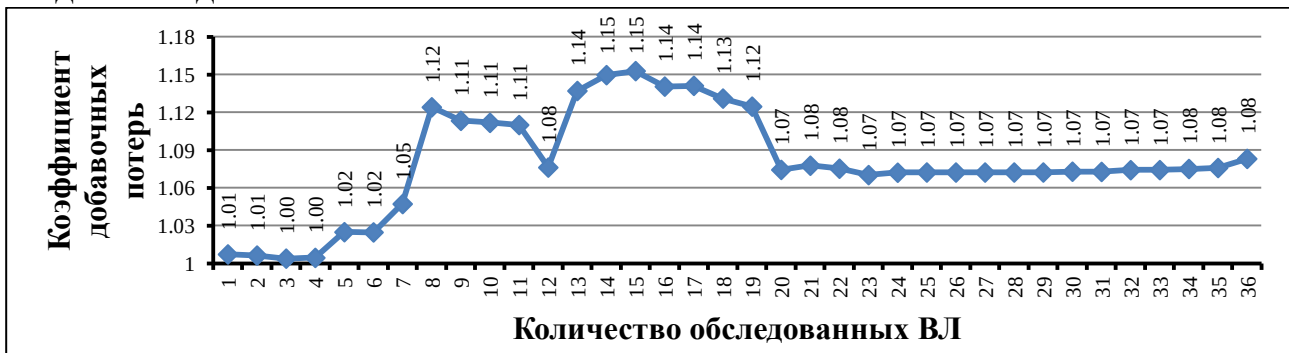
Рис. 13. Сходимость ВЛ 110 кВ ОАО «Бурятэнерго» по \tilde{k}_{\text{дп.ВЛ.ЭС}}
