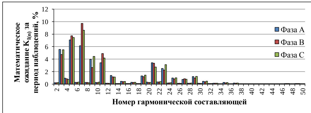
Рис. 9. Измеренный гармонический состав токов в ВЛ
