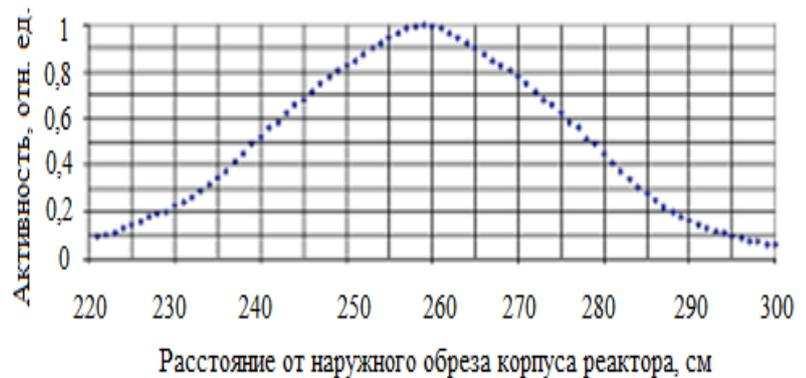
Рис. 8. Распределение плотности потока тепловых нейтронов по длине ГЭК-4
