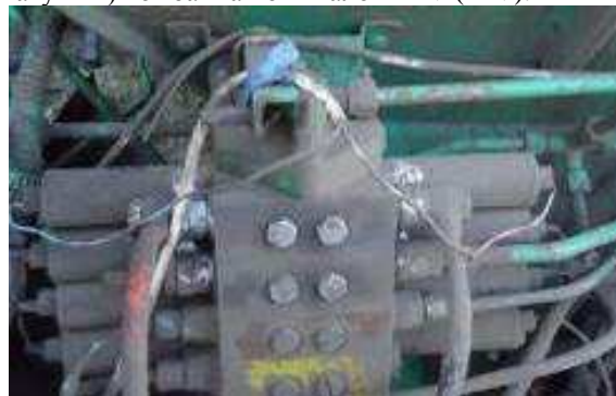
Рис. 1. Электро-гидра распределитель комбайна
