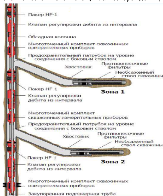
Рис. 2. Устройство интеллектуальной скважины
