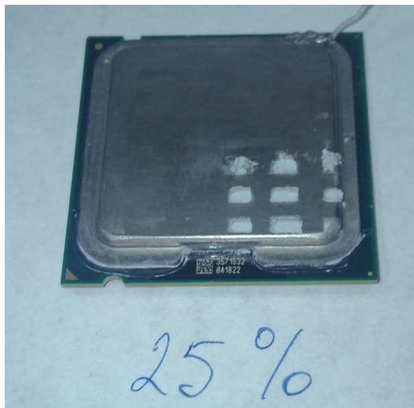
Рисунок 65. Нанесенный термоинтерфейс на корпус процессора для случая использования 25% площади поверхности корпуса процессора
