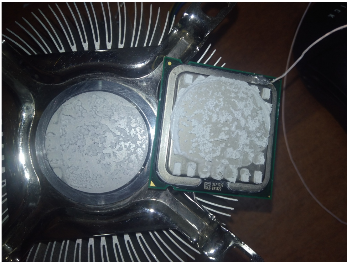
Рисунок 58. Распределение термоинтерфейса по поверхности корпуса процессора и радиатора охлаждения
