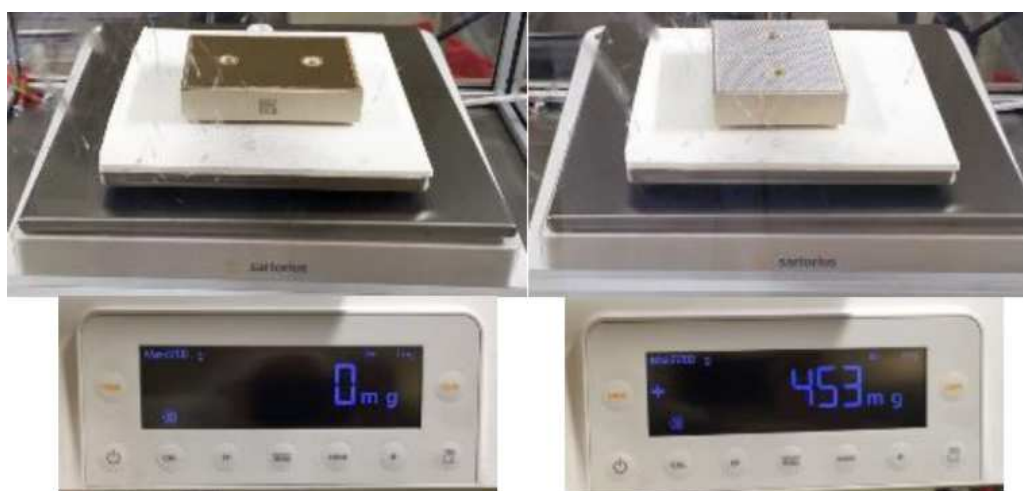
Рисунок 9. Пример измерения массы нанесённого термоинтерфейса
