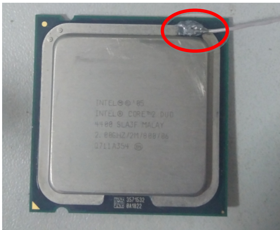
Рисунок 53. Проводник, припаянный к корпусу процессора
