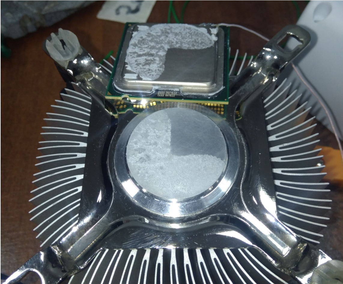
Рисунок 61 Распределение термоинтерфейса по поверхности корпуса процессора и радиатора охлаждения при 75% занятой площади
