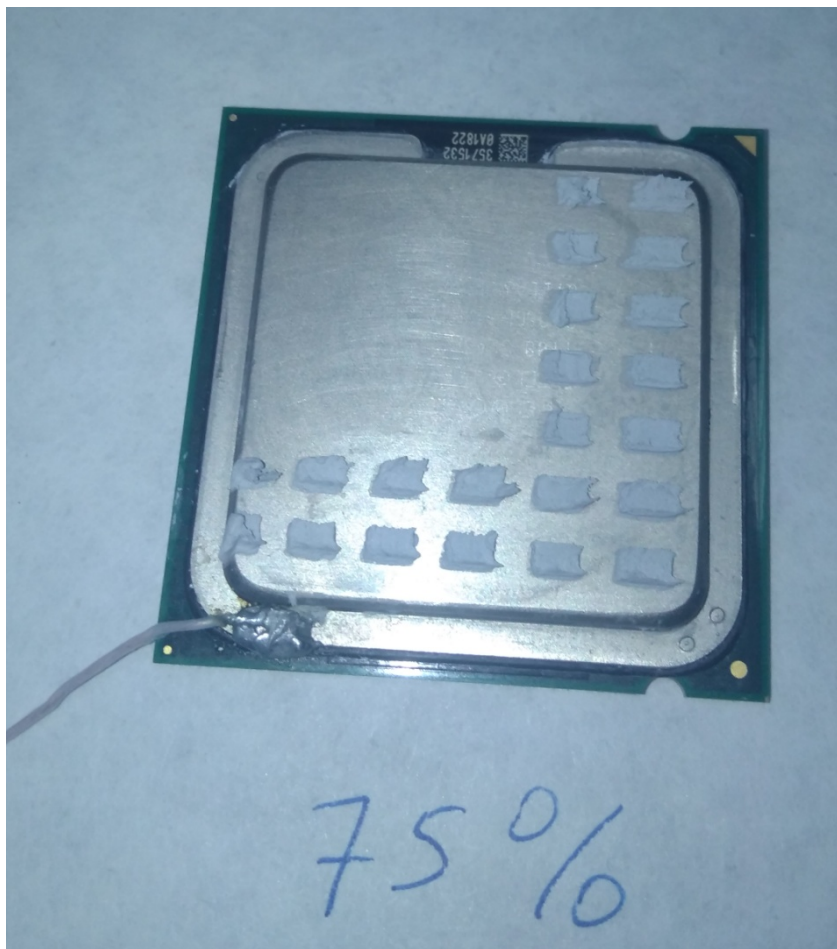
Рисунок 59. Крышка процессора с нанесенным на 75% площади через трафарет термоинтерфейсом
