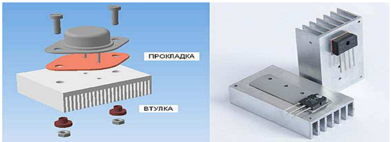
Рисунок 6. Пример использования теплопроводящих прокладок для монтажа ЭРИ
