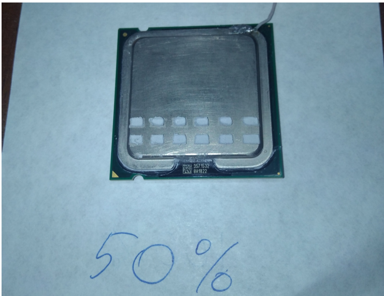
Рисунок 62. Крышка процессора с нанесенным на 50% площади через трафарет термоинтерфейсом
