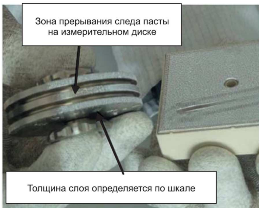
Рисунок 15. Пример использования дискового гребенчатого толщиномера
