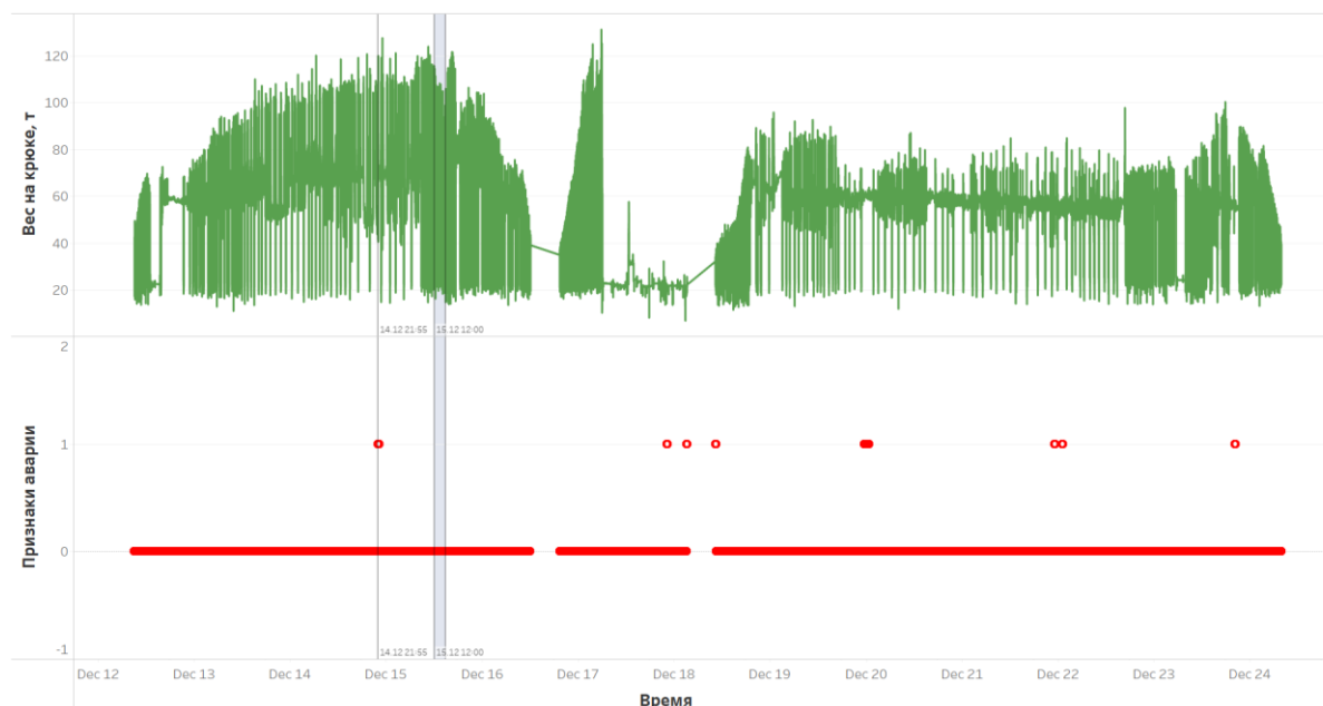
Рис. 10. Результаты работы алгоритма иерархической временной памяти на тестовой выборке, скважина № 2 Fig. 10. Hierarchical temporal memory results on test dataset, well no. 2
