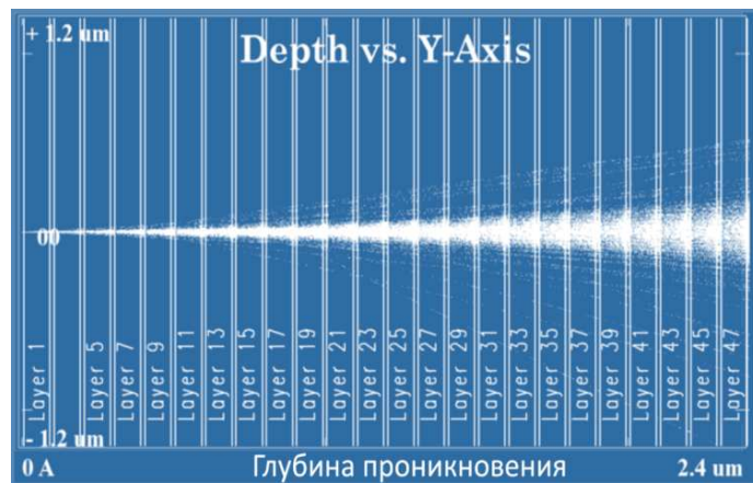
Рисунок 72 – Траектория протонного пучка в кластере, образованном частицами диоксида кремния размером 100 нм
