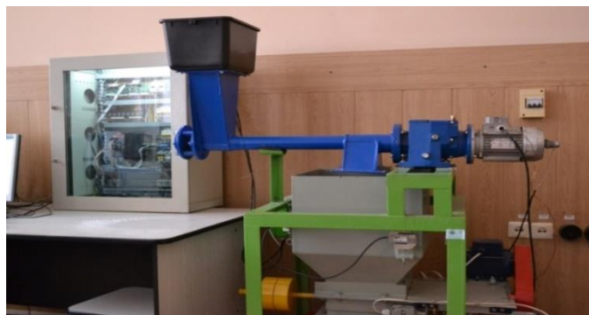
Рис.13 Экспериментальный научно-исследовательский стенд «Автоматическая система дозирования сыпучих материалов на базе микроконтроллера Fastwel RTU 188 BS»
