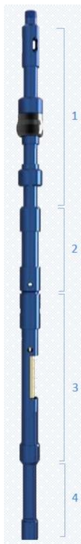
Рисунок 13 – Десендер ФМГ-01: 1 – манжетный разобщитель затрубного пространства; 2 – клапан прямого прохода; 3 – модуль пескосепарирующий; 4 – контейнерные накопительные трубы НКТ
